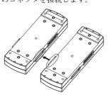
②連結板を付属のネジで固定します。 推奨締め付けトルク: 14 k g f/c m M4X6サラネシ
