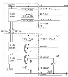
\*1 投光停止: Vs-3V~Vsに短絡通常動作: OV~1/2Vsに短絡またはオープン
