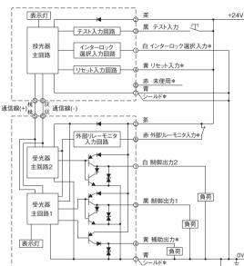
■外部リレーモニタ機能を無効にする配線 外部リレーモニタ入力を補助出力へ短絡してください。
