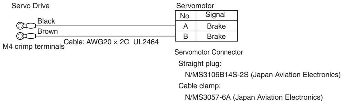
■ Brake Cables (Robot Cables)
